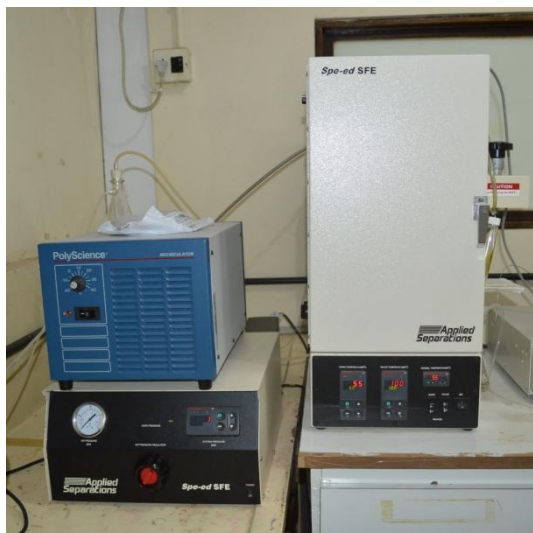
Figura 7 – Extração por fluido supercrítico
